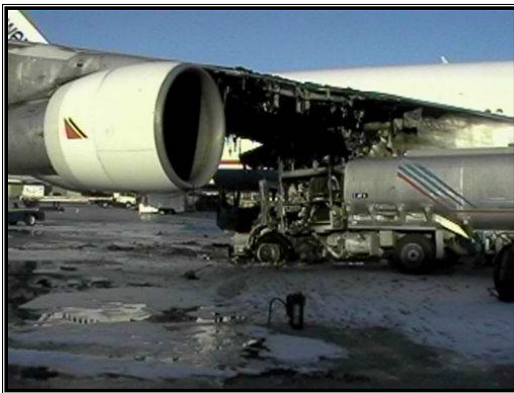
Fig 43 -Incêndio ocorrido durante uma operação de reabastecimento
